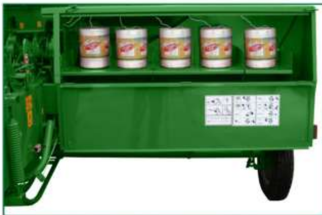
Նկ.7. SIPMA PK-4000 KOSTKA Z-224/1 հավաքիչ-մամլիչի կապող թելերի բունկերի ընդհանուր տեսքը:
