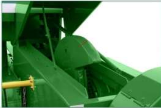
Նկ.3. Շուտովիկ-շարժաթևային մեխանիզմը հավասարակշռող հակաձանրոցով:
