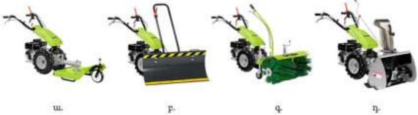
Նկ.6. Հնձիչի հետ ագրեգատավորվող գործիքների հարմարադասման սխեմաները.
